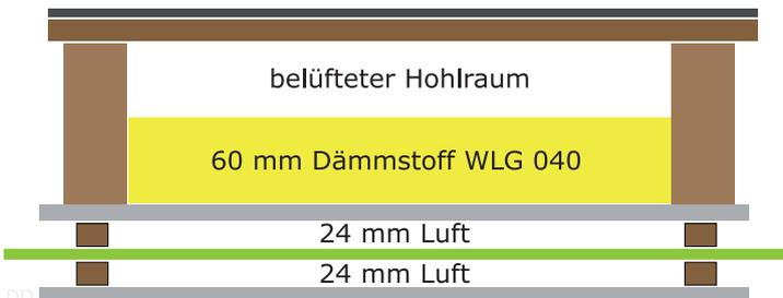
mit einer Lage ISUM MF 14 unter der vorhandenen Dämmung - reduziert zusätzlich den sommerlichen Wärmeeintrag um 62 %
