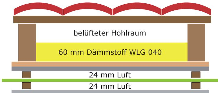
mit einer Lage ISUM MF 14 als Dämm- und Luftdichtungsfolie unter einer vorhandenen Zwischensparrendämmung
