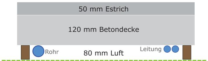
mit einer Lage ISUM MF 14 M und 80 mm Luftschicht unter einer ungedämmten Betondecke
